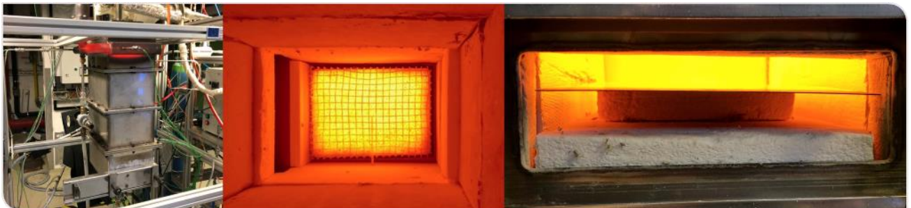
Abb. 1 links ECCO Laborofen, Mitte: Porenbrenner im Laborofen, rechts: Beschickungsöffnung Laborofen
