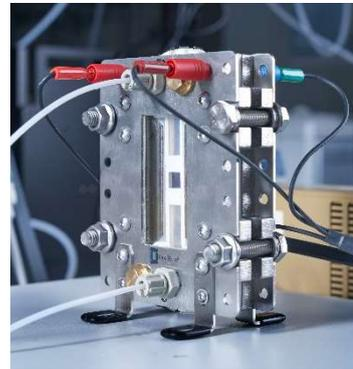
Fig.1. Flusszelle für die CO<sub>2</sub>-Elektrolyse
