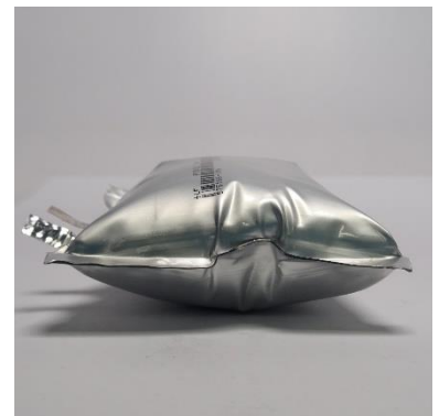
Abbildung: Trockene Lithium-Ionen Batterie (links), Messaufbau für Formierung (mitte), Lithium-Ionen Batterie mit signifikanter Gasbildung (rechts)
