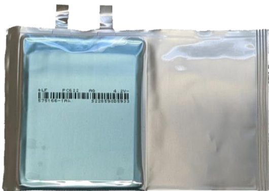
Abbildung: Trockene Lithium-Ionen Batterie (links), Messaufbau für Formierung (mitte), Lithium-Ionen Batterie mit signifikanter Gasbildung (rechts)
